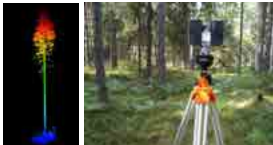
Med 3D skanning kan träråvara eller byggnation utifrån en specifik plats skräddarsys efter specifika behov hos slutprodukterna. 3D skanning av byggnader ger även möjligheter för snabbare inventering av material inför rivning. Bild:Skogsforsk
